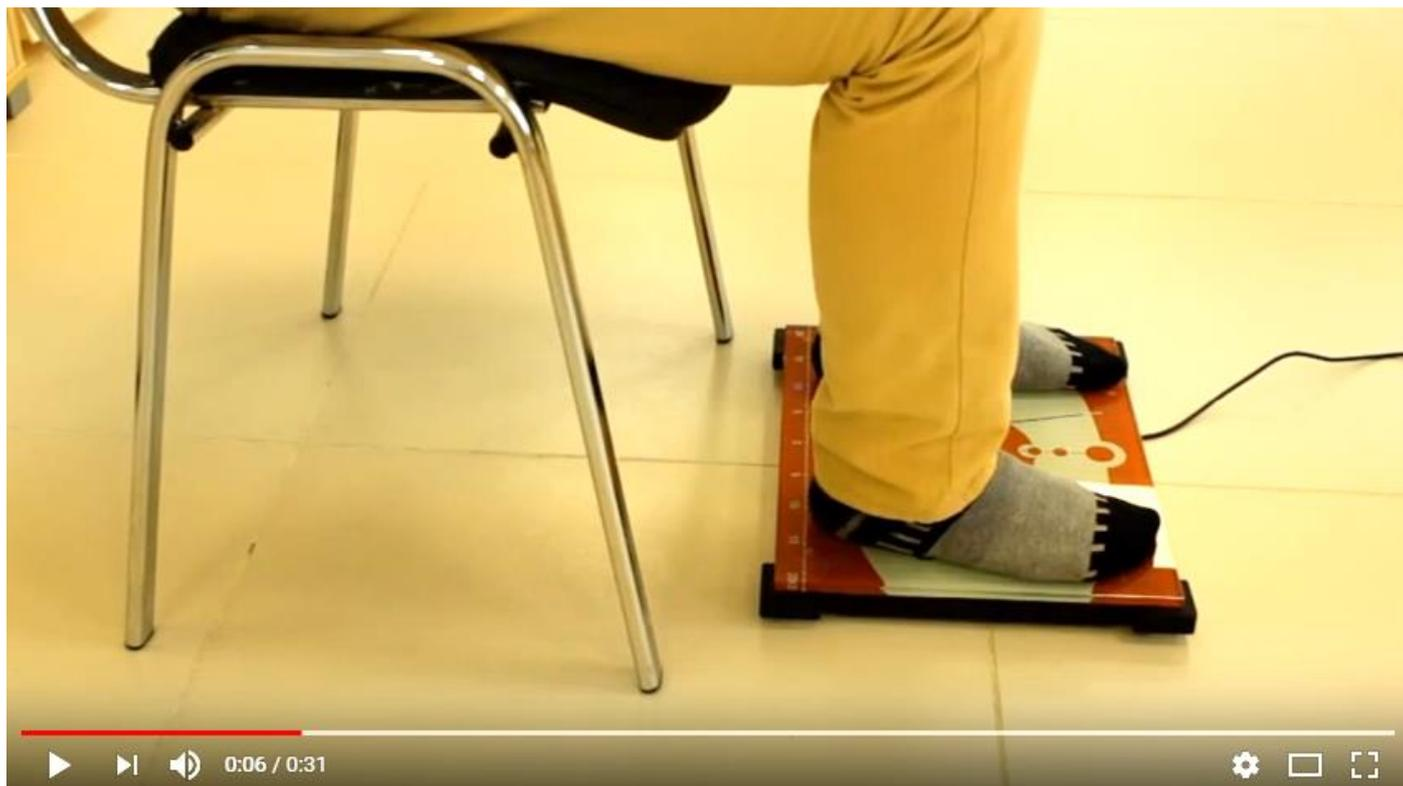
Рисунок 7. Положение испытуемого «сидя, упор ногами на стабилоплатформу».
