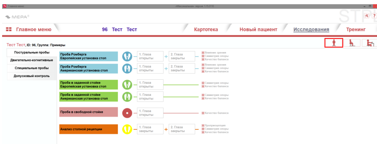
Рисунок 4 – Пример переключения кнопок модулей для разных конфигураций в режиме проведения тестов – кнопки справа сверху (вариант интерфейса: в различных конфигурациях системы число и вид кнопок может отличаться в зависимости от наличия модулей)
