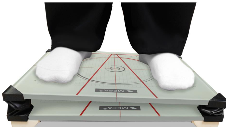
Рисунок 31 – Пример (вариант исполнения) динамической опоры – качающейся накладки на стабиллоплатформу
